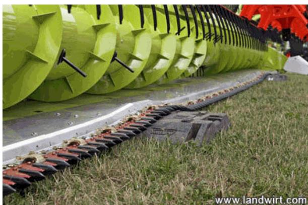
**Abbildung 8: Flexibler Messerbalken (Maxflex) der Firma Claas**
