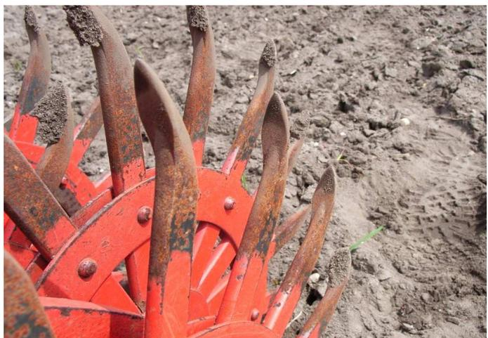
arbeitet sie deshalb auf lehmigen Böden, da größere zusammenhängende Bodenbestandteile gelöst werden und so der Boden größtenteils auch vollständig bearbeitet wird. Aufgrund der lockeren Struktur auf Sandböden bleiben zwangsläufig Bereiche der Bodenoberfläche unbearbeitet. Durch eine doppelte Überfahrt sollte eine möglichst vollständige Bearbeitung der Bodenoberfläche erreicht werden.
