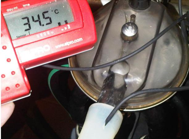
Bild 3: Langzeittemperaturmessung am Melkzeug mittels Datenlogger
