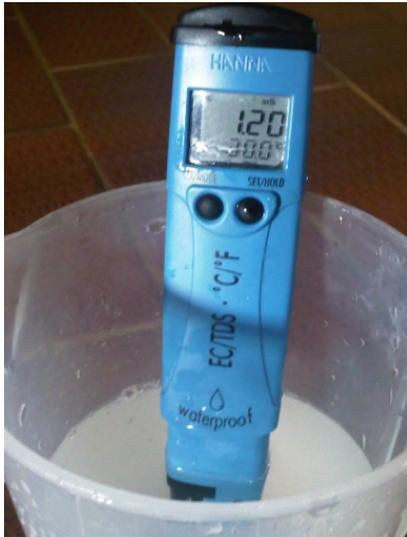
Bild 5: Bestimmung der Konzentration der Reinigungslösung mittels temperaturkompensierter Leitfähigkeitsmessung.
