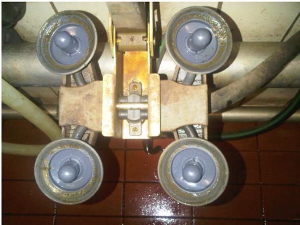
Bild 4: Melkzeugspülaufnahmen müssen regelmäßig manuell gereinigt werden.
