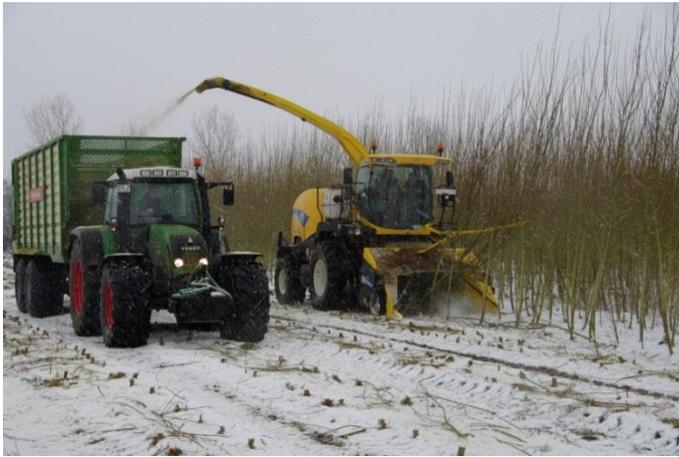
Abb. 3-3: Ernte von Energieholz aus einer Kurzumtriebsplantage
