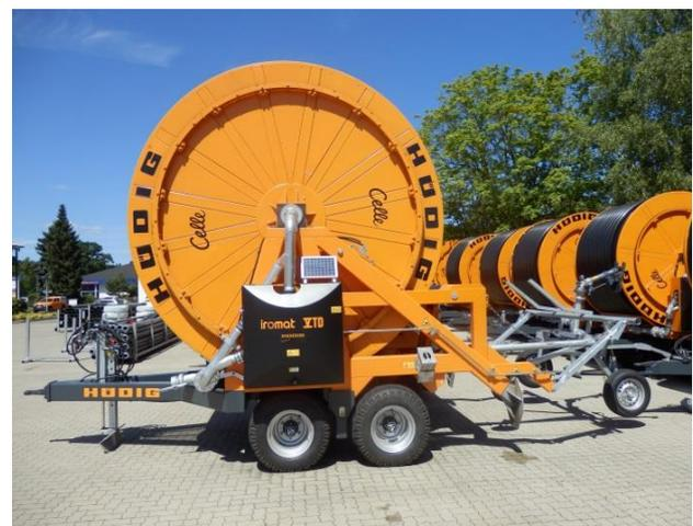
**Bei der Neuanschaffung von Beregnungsmaschinen ist auf eine straßenverkehrstaugliche Ausstattung zu achten. An dieser Maschine ist eine Luftdruckbremse verbaut.**
