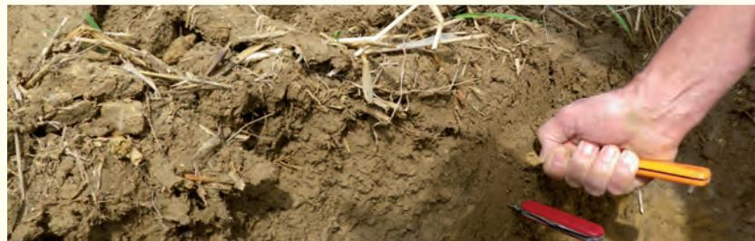
*Mit dem Messer wird die Dichte des Bodens geprüft. Der Praktiker kann mit dieser neuen Methode schnell beurteilen, wie es um die Bodenstruktur bestellt ist.*
