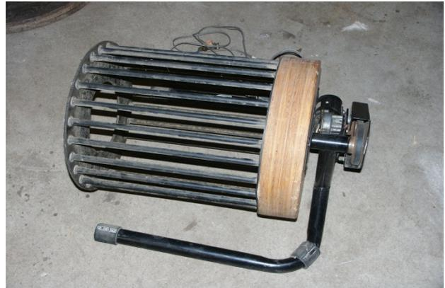
**Abb. 6: Rotierender Käfig zur Untersuchung der Schalenfestigkeit des Erntegutes**
