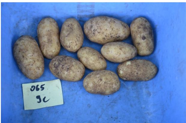
**Abb. 7: Losschalige Knollen nach mechanischer Belastung im Testgerät**
