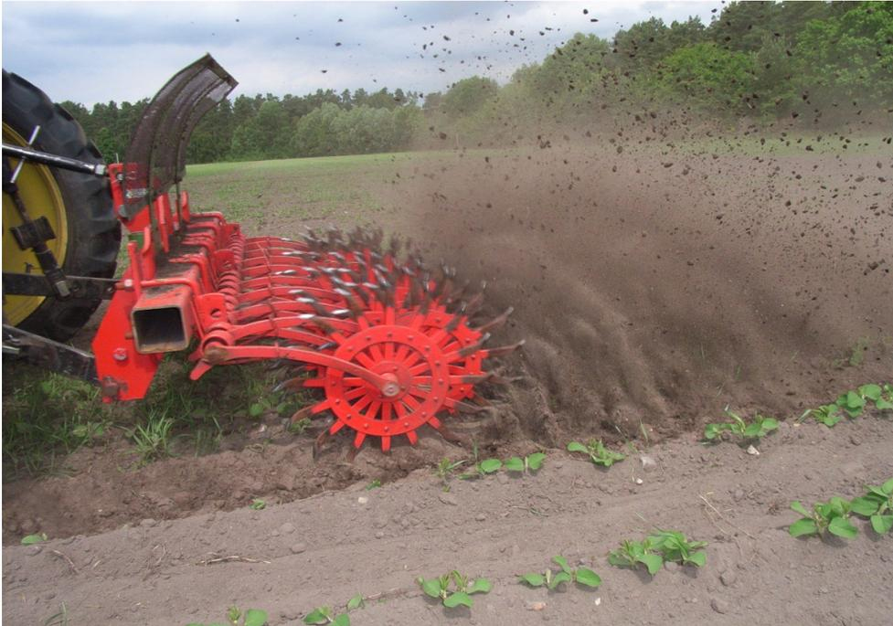
**Abbildung 17: Einsatz der Sternrollhacke (Rotary Hoe) in Soja**
