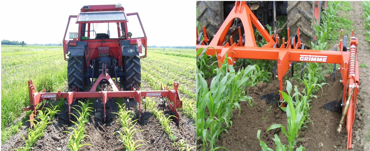
**Abb. 7: Häufelgerät ohne Dammformblech im Einsatz**
