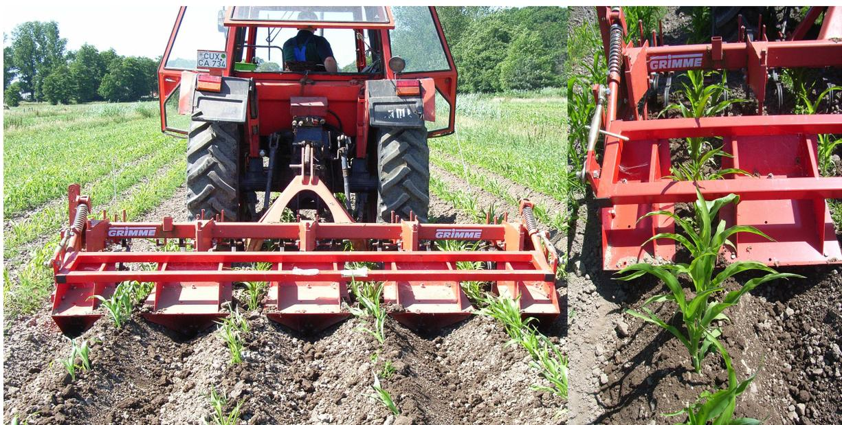
**Abb. 8: Häufelgerät mit geteiltem Dammformblech für wachsende Bestände**
