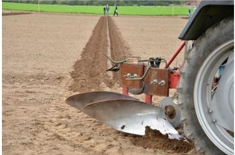
Die **Drehpflüge** werden heute in der Praxis bevorzugt, weil mit ihnen eine gleichmäßigere, ebenere Oberfläche erzielt wird. Da mit dem Drehpflug keine Beete angelegt werden müssen, sinken die Wendezeiten. Außerdem kann während des Pflügens bereits mit der Bestellung begonnen werden. Des Weiteren lassen sich ungleichmäßig geformte Schläge leichter pflügen.
