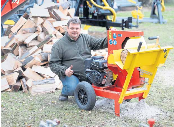
Jörg Hoster präsentiert die Benzinmotor-Wippsäge Xyloscie 600 M mit Keilriemenantrieb und Haltekralle.
