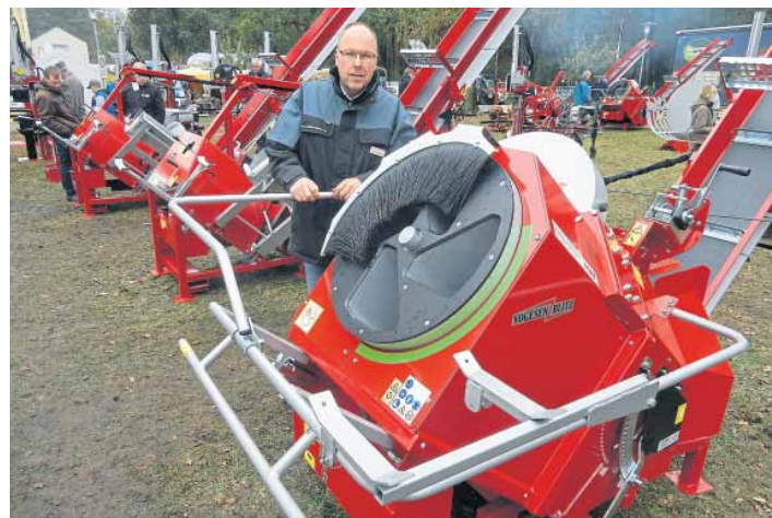
Die Trommelsäge Quadromat von AMR/Unterreiner, vorgestellt von Klaus Goldbeck, wird über vier Schächte bestückt.
