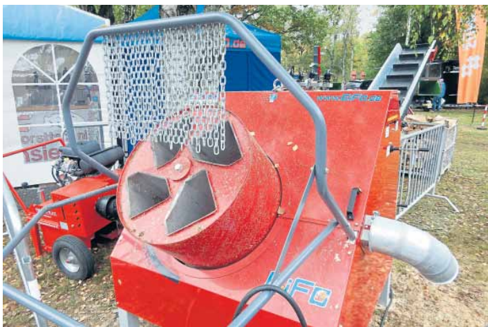
Die Highspeed-Trommelsäge des Herstellers EiFo ist für bis zu 15 Raummeter pro Stunde ausgelegt.
