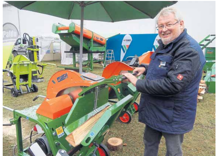
Helmut Steep zeigt die Posch Wippsäge mit Sicherheitskorb, für den sich bereits die Hälfte der Kunden entscheidet.
