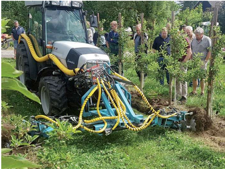
Abb. 6: Spedo Scheibensech beim Arbeiten.
