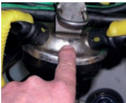
Kleine Ursache große Wirkung, die Lufteintrittsbohrung im Milchsammelstück.
