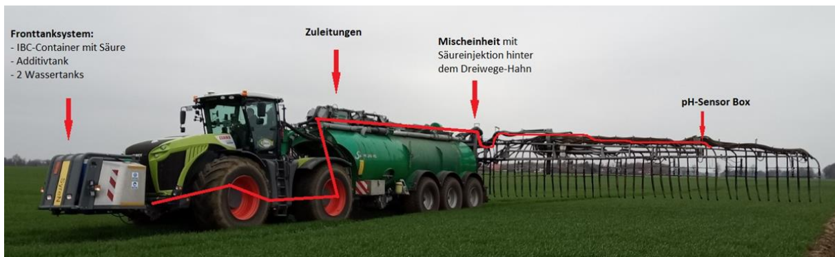
Abbildung 4: Technische Umsetzung der Gülleansäuerung mit dem SYRE-N-System der Firma BioCover. Konzentrierte Schwefelsäure wird aus einem doppelwandigen IBC-Container über säurebeständige Leitungen der Mischeinheit zugeführt und dort direkt in den Güllestrom injiziert. Der pH-Wert wird kontinuierlich über einen Sensor im Gestänge überwacht.
