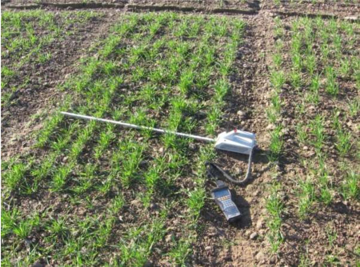
**Abbildung 2: Erfassung der Lichttransmission in Winterweizen zum Zeitpunkt der Bestockung mittels Sunscan-Analyzers (Delta-T, GB) und tragbarem Kleincomputer (Aufnahme: Wunderlich, 2010)**
