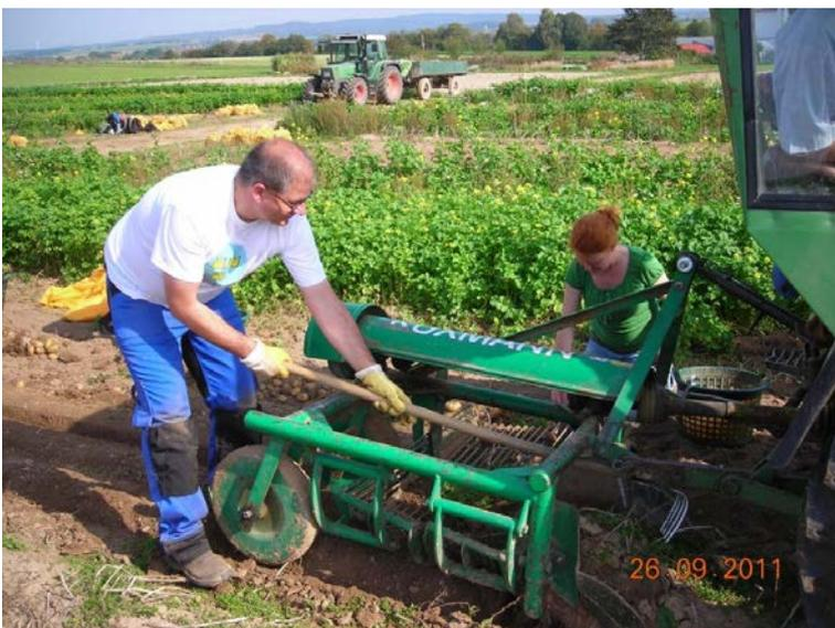
**Abbildung 9: Durchführung der Zeiternte mit dem Schwingensiebroder**
