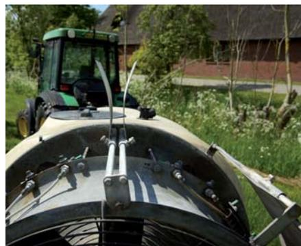
Abb. 1: Um 75% Abdriftminderung zu erreichen sind neben dem maximalen Gebläsedurchmesser von 920 mm auch Luftestellbleche und eine einseitige Gebläseabdeckung Voraussetzung.
