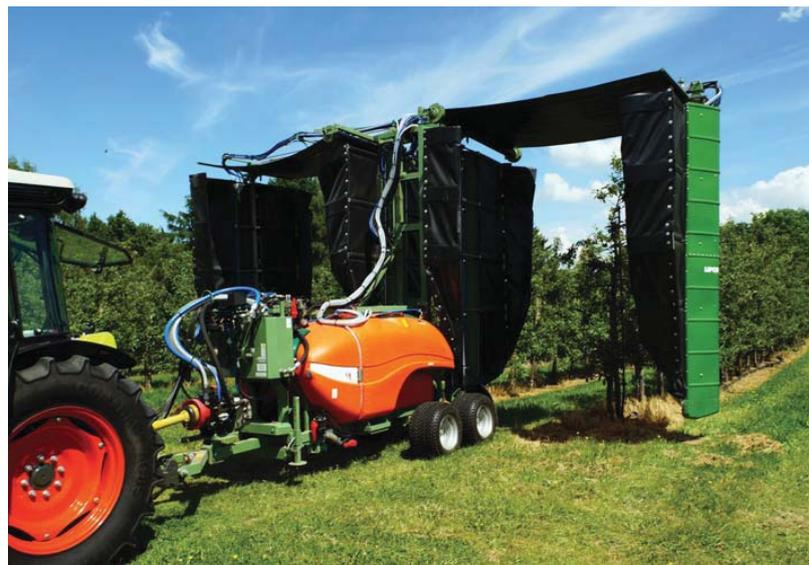
Abb. 4: Zweireihiges Tunnelsprühgerät Typ NVM2.
