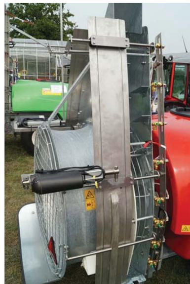
Abb. 3: Beidseitig verschließbare Luftauslässe ermöglichen in der Pufferzone die einseitige Luftabschaltung an beiden Geräteseiten, wie hier am Wanner N36GA zu sehen.
