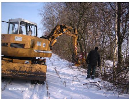
Der "Schnitt-Griffi" ist zwar leistungsfähig, hinterläßt aber durch das Kneifsystem ein ausschlagfeindliches Schnittbild
