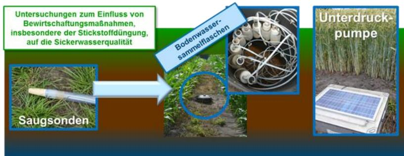
Das Sickerwasser wird in den Sammelflaschen aufgefangen und anschließend auf Nitrat analysiert.
