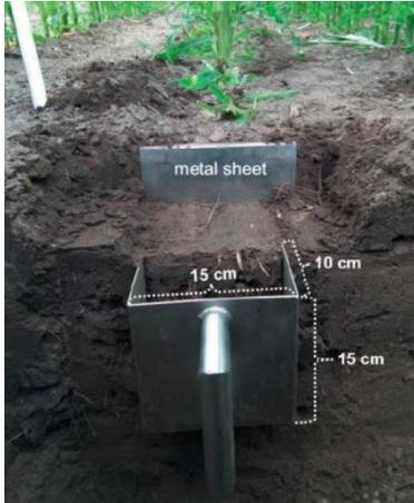
**Abbildung 139:** Probenahme mithilfe einer speziell angefertigten Schaufel, um bei Gülleunterfußdüngern repräsentative Ergebnisse zu erhalten (WESTERSCHULTE et al. (2015))
