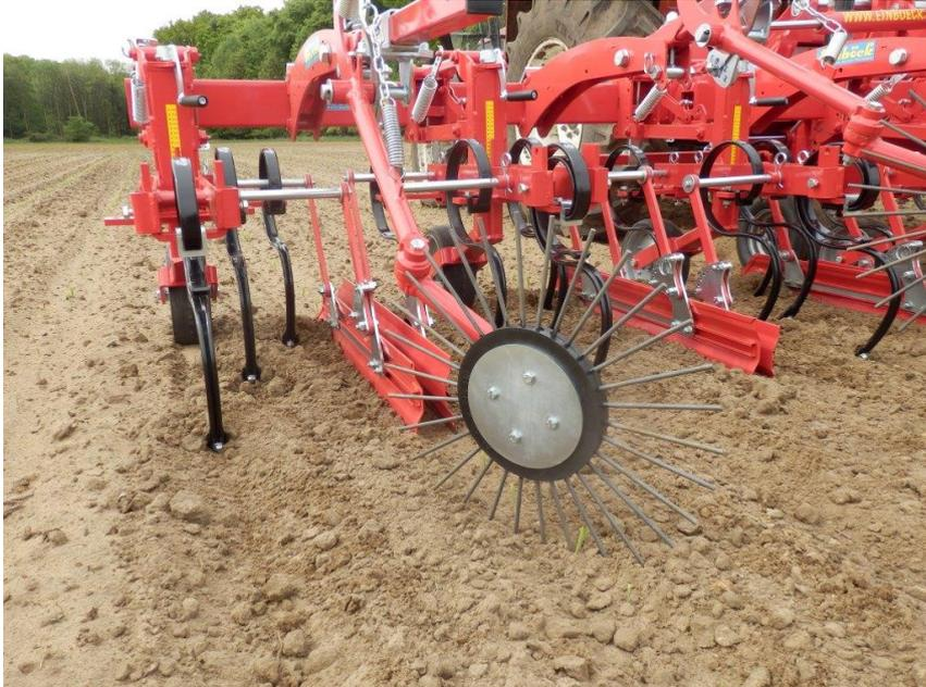
**Abbildung 17: Einsatz des Rollstriegels zur Regulierung innerhalb der Maisreihen im frühen Aufgang**
