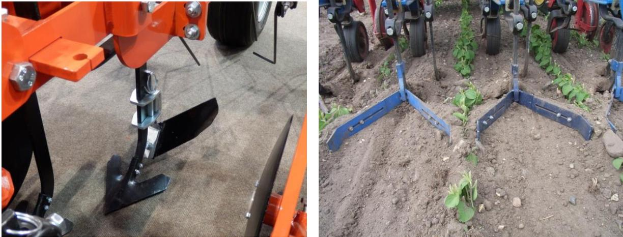
**Abbildung 21: Häufelschare/Leitbleche am Hackschar (links) und Flachhäufler zum Anbau am Hackschar in Soja im Einsatz (rechts)**
