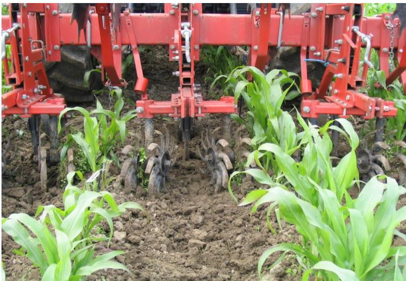
**Abbildung 19: Später Einsatz der Rollhacke mit häufelnder Arbeitsweise**
