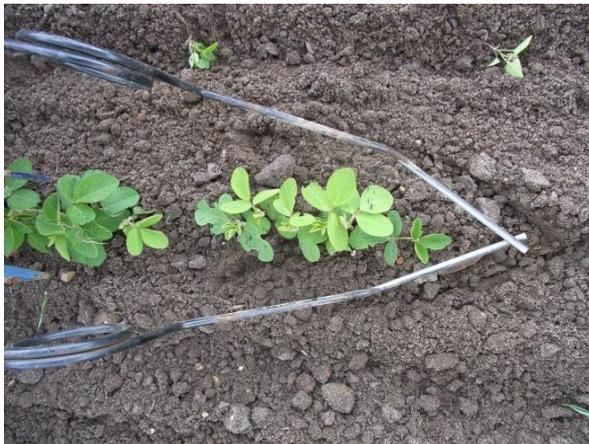
**Abbildung 18: Die Torsionszinken (Links: in Sojabohnen im Einsatz)**
