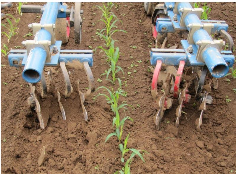
**Abbildung 20: Früher Einsatz der Rollhacke**
