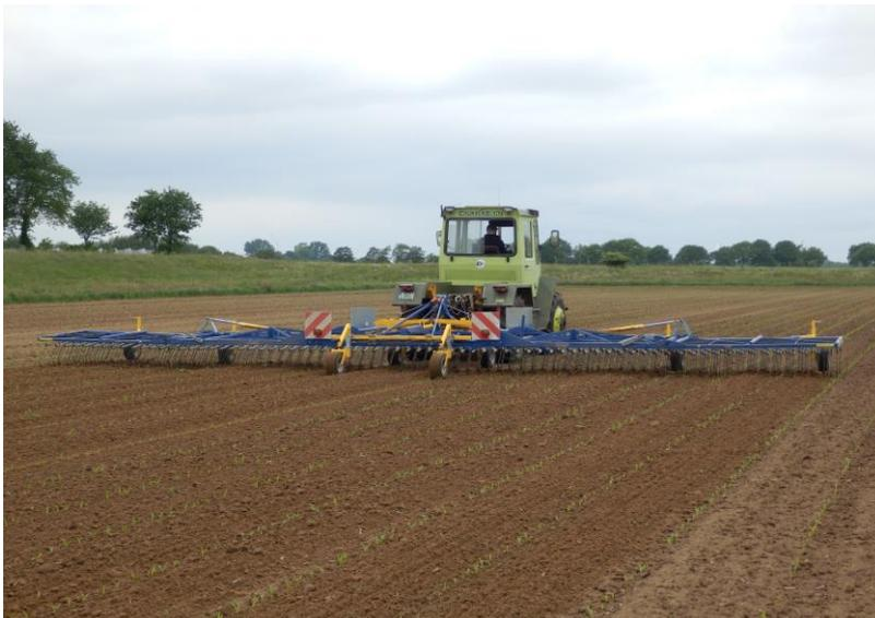
Abbildung 10: Treffler-Striegel im Einsatz in Mais
