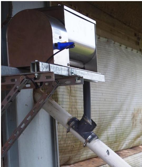
**Abbildung 3: Einmischen der Pflanzenkohle mittels Dosiereinrichtung in das Futterrohr**
