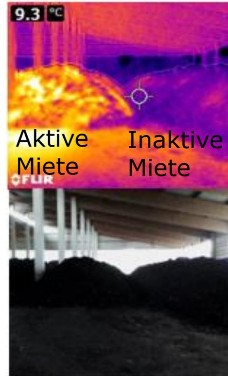
Bilder: Andere Anwendungsbereiche für Wärmebilder auf einer anaeroben Bioabfallbehandlungsanlage mit Nachkompostierung (Bildquelle: Wiese)
