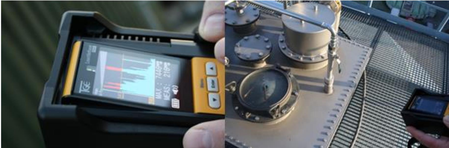
Bild: Laserhandmessgerät zur Methanleckortung (links), Vermessung des Kopfteils eines Anaerobreaktors mit diesem Gerät (rechts) (Bildquellen: Wiese)
