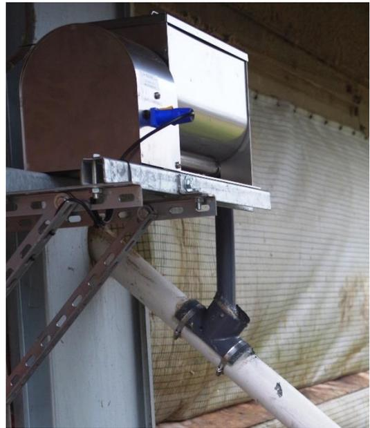
Abbildung 61: Dosiereinrichtung für die Pflanzenkohle
