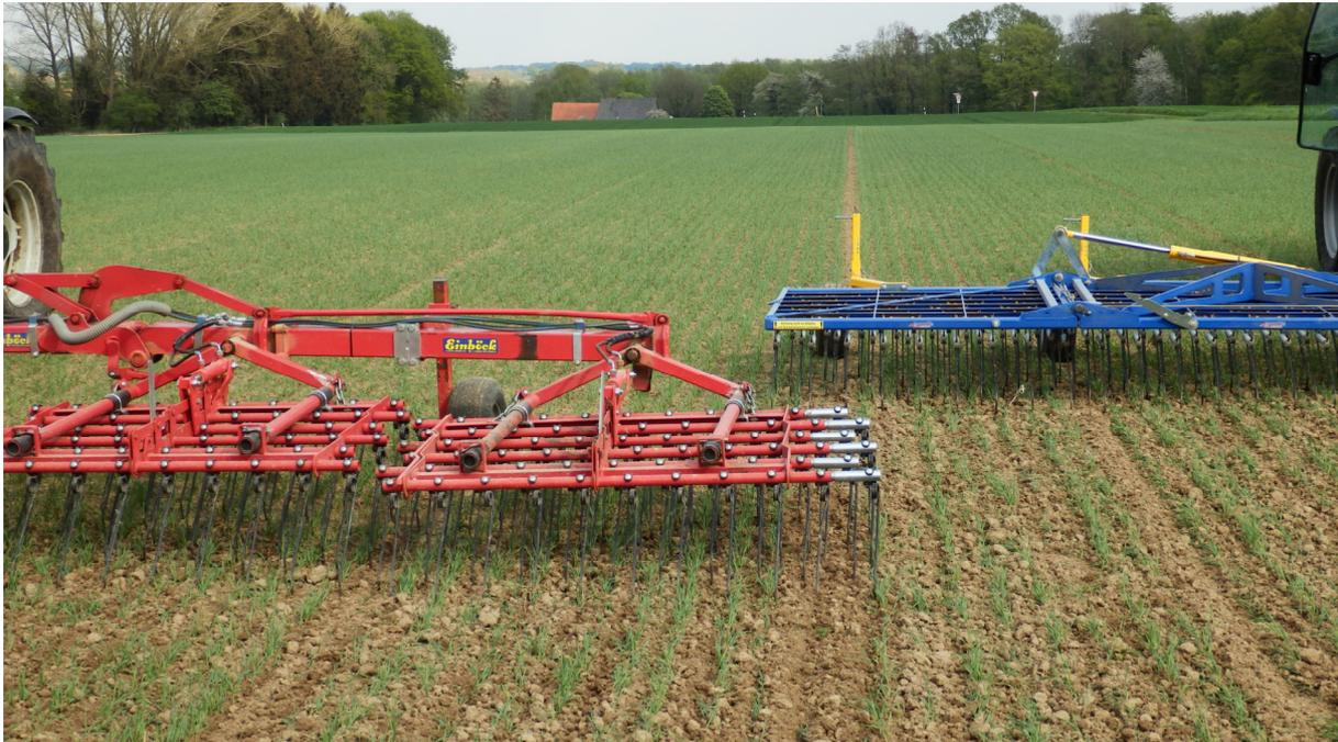
**Abb. 3: Angeboten werden Striegel mit direkt (links) und indirekt (rechts) gefederten Zinken**
