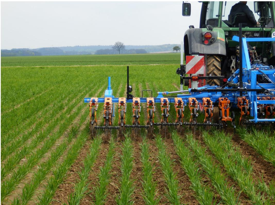
**Abb. 7: Einsatz einer kamerageführten Scharhacke im Getreide**
