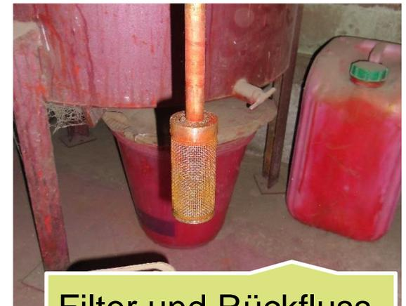
Filter und Ventile müssen auswechselbar und in Ordnung sein
