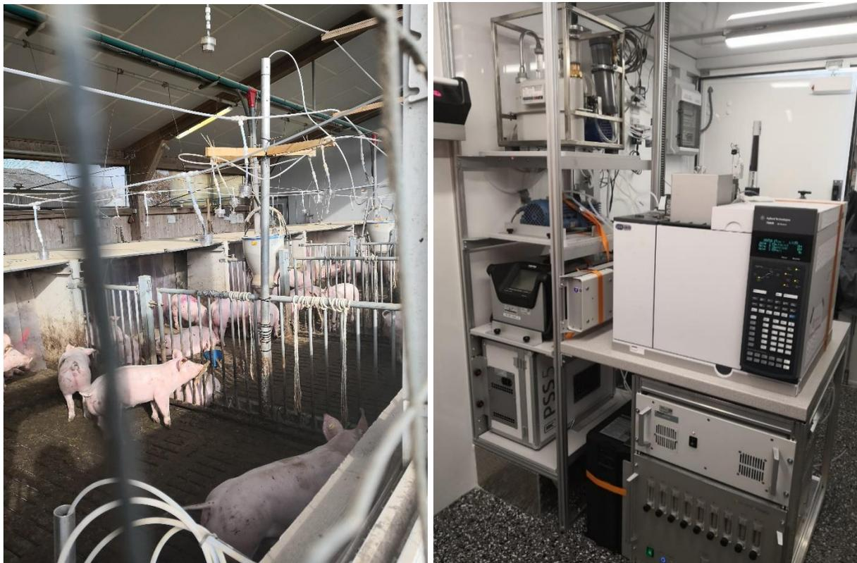
Abbildung 38: Zur Emissionsmessung in den freigelüfteten Ställen wurde ein Tracergas eingesetzt und mit Hilfe von Messsonden abgesaugt und im Messfahrzeug mit hochempfindlichen Messgeräten analysiert
