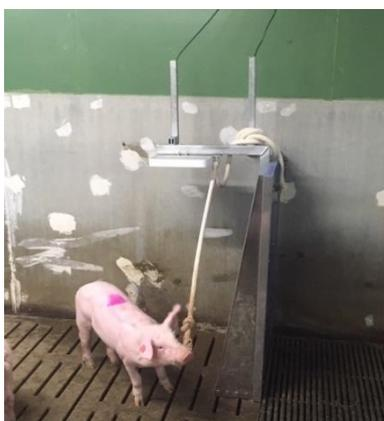
Abbildung 42: Bite-o-Mat in der Mast zur Messung des Manipulationsverhaltens der Tiere an einem Baumwollseil
