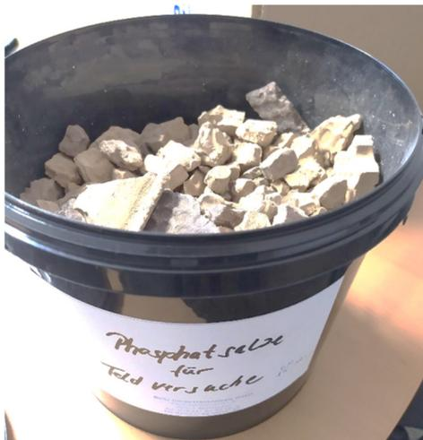
Abbildung 1: Das mit dem NuTriSep-Verfahren gewonnene P-Salz stößt auf großes Interesse (ca. 20 %  $P_2O_5$ -Gehalt), muss aber noch konditioniert werden, damit eine Ausbringung mit dem Düngerstreuer erfolgen kann., Foto: J. Evers
