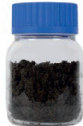
Abbildung 2: Separierter Feststoff mit 28% TS.
